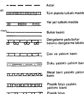
12 Çati yalıtım yapımının sembollerle gösterilmesi.
